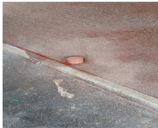
Figur 12: MMA's reaktion vid kontakt med fukt
