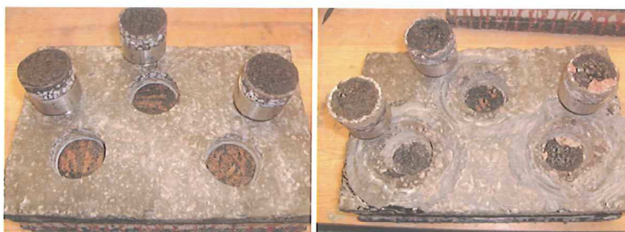
Figur: Provpplattor med aktuellt system efter provdragnings, utan exponering (vänstra bilden) och efter exponering (högra bilden). MMA primern är rosa till färgen.
